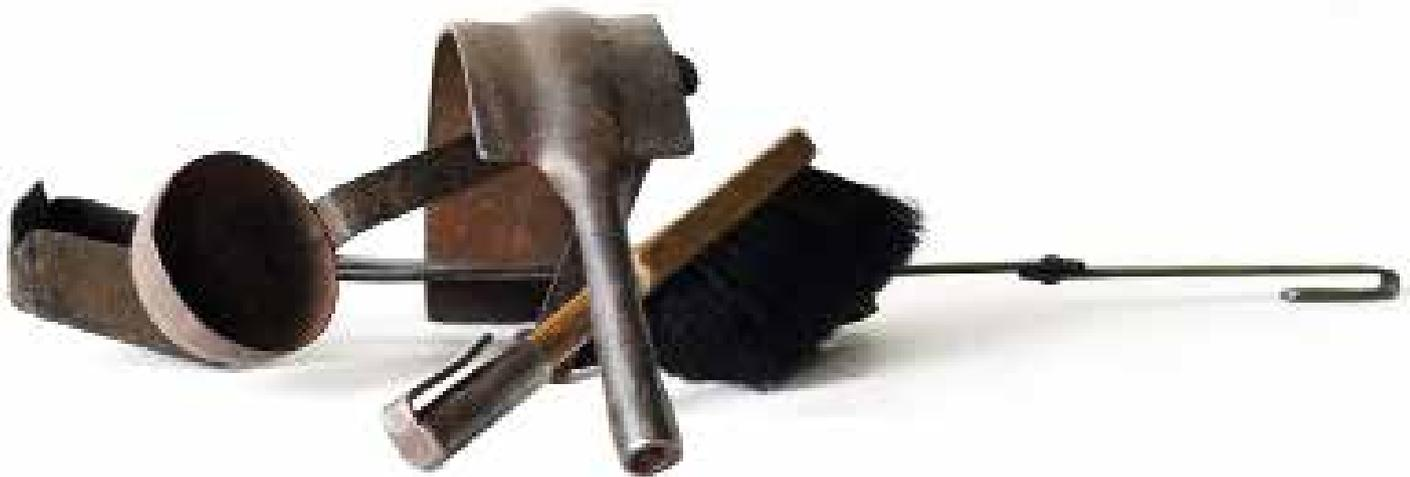
Zum Handwerkszeug eines Schornsteinfegers, dem so genannten Kellzeug, gehörten neben dem Schultereisen und dem Besen auch eine Kelle zum Entfernen des Rußes. Mithilfe dieser flachen, fünf bzw. dreigliedrigen runden (für Öfen) und eckigen (für Schornsteinsohlen und Füchse) Kelle mit Gelenkgriff, gelang es dem Schornsteinfeger, den Ruß aus dem hinteren Ende des Schornsteinkanals zu holen. Die Schornsteinfegerkelle wurde anlässlich der Sonderausstellung „Feuermauerkehrer. Vom Wan-
